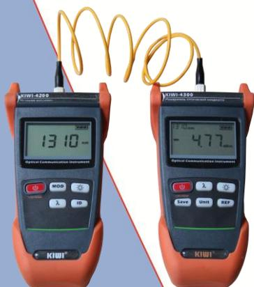
Измерители мощности KIWI-4300 в сочетании с источниками излучения серии KIWI-4200 - это крайне эффективное средство измерения затухания оптических каналов на наиболее распространенных длинах волн – 1310 нм и 1550 нм.
