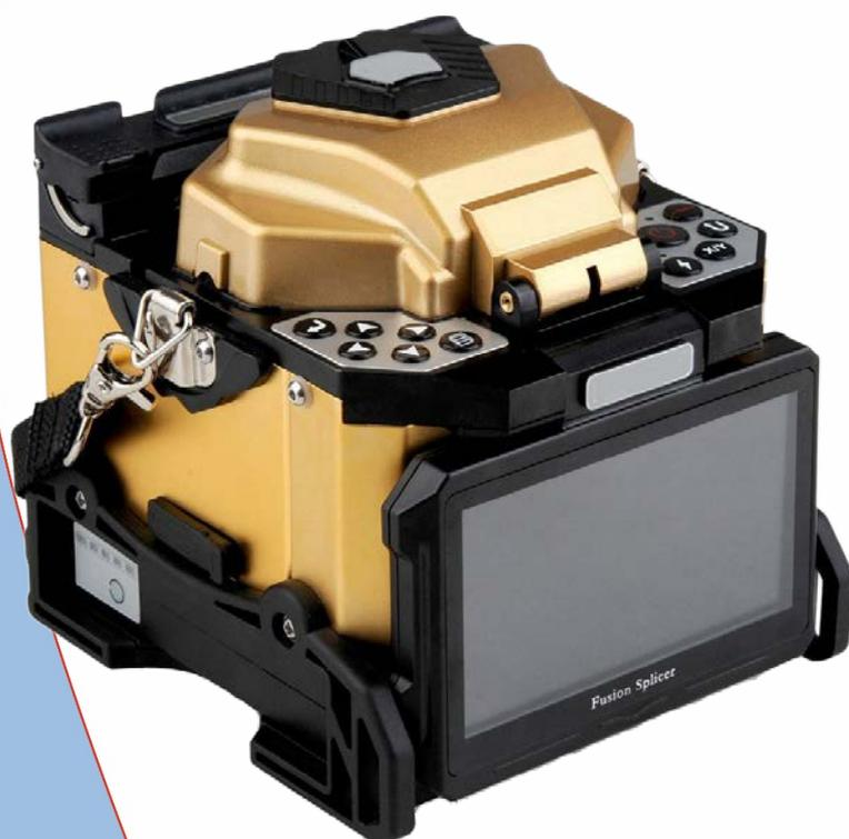
Сварочный аппарат **KIWI-6195** - это новое поколение сварочных аппаратов от компании «КивиТех», зарекомендовавшей себя на рынке как производитель надежных, простых в использовании и экономичных аппаратов. KIWI-6195 имеет малые размеры и вес, быстрое время сварки и термоусадки, а также доступную цену и исчерпывающую комплектацию.
